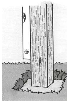
4. Stellen Sie das Einbauteil in die gewünschte Position und korrigieren Sie dieses innerhalb von 2 Minuten. Das Teil braucht danach nicht mehr gestützt werden. Die Oberflächen kann sofort geglättet werden.
