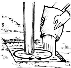
2. Stellen Sie das Einbauteil in der Mitte des Loches und füllen das Loch mit Schnellbetonmörtel gleichmäßig ohne zu vermischen. Heben Sie das Einbauteil sofort nach dem füllen ein wenig an, so dass der Mörtel auch unter das Einbauteil läuft.
