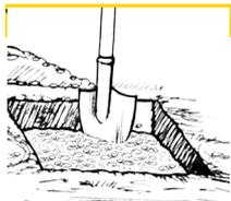
1. Graben Sie ein Loch an der richtigen Stelle in den gewünschten Abmessungen. Gießen Sie das Loch halb voll mit sauberem Wasser.
