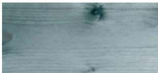
Unbehandelte Oberfläche Folge: Holz vergraut vollflächig
