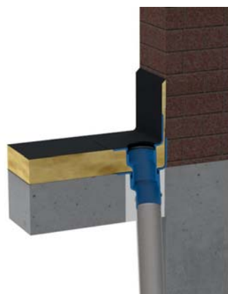
Zwei Attika-Balkonabläufe senkrecht direkt an der Wand verbaut
