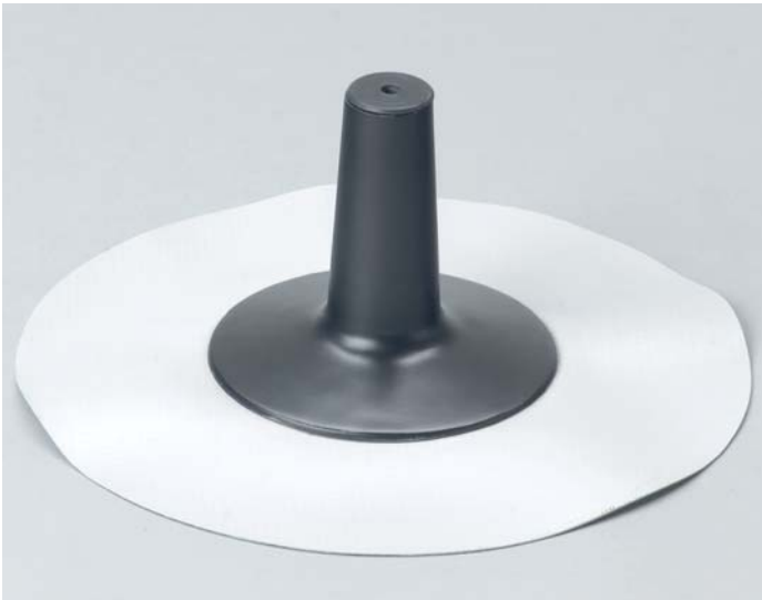
Befestigungsdurchführung aus PUR (schwarz) wärmegeklämt, FCKW-frei, mit integrierter Gummidichtung und eingeschäumter Anschlussbahn (Bitumen, PVC oder Sonderfolie).
