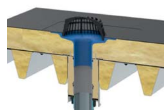
Kompakt-Brandschutz-Gully DN 100 mit eingestecktem Eco-Gully-Oberteil im Trapezblechdach mit Warmdachaufbau.
