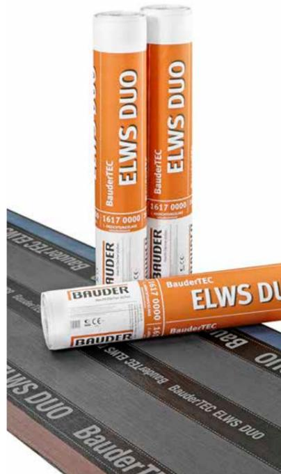
Kaltselbstklebende erste Abdichtungslage aus Spezial-Elastomerbitumen mit variabler Nahtverklebung: Kaltverklebung im Nahtbereich und in der Fläche oder Kaltverklebung in der Fläche und Verschweißung der Längs- und Quernähte. Die gewünschte Art der Nahtverbindung kann jederzeit vor Ort festgelegt und wieder geändert werden.
