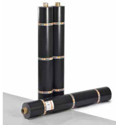
BauderTHERMOFOL M sind Kunststoffdachbahnen für die lose Verlegung, mechanisch befestigt, die in den Dicken 1,5 bis 2,0 mm hergestellt und mit einer Synthefaserverstärkung versehen sind. Dies verleiht ihnen die Dimensionsstabilität, eine hohe Festigkeit sowie eine den Anwendungen exakt angepasste Dehnung.
