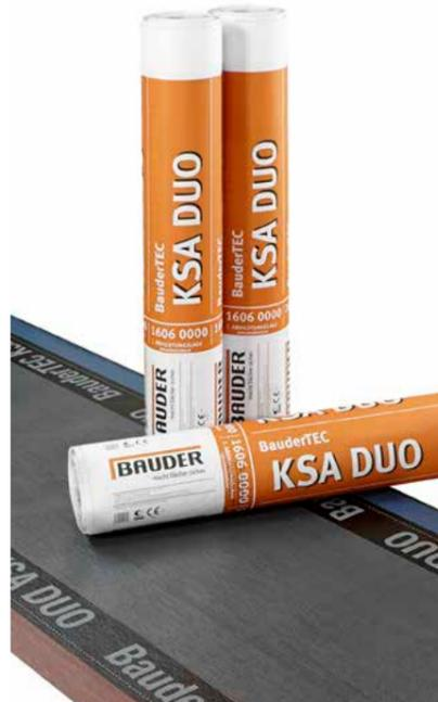
Kaltselbstklebende erste Abdichtungslage aus Spezial-Elastomerbitumen mit variabler Nahtverklebung: Kaltverklebung im Nahtbereich und in der Fläche oder Kaltverklebung in der Fläche und Verschweißung der Längs- und Quernähte. Die gewünschte Art der Nahtverbindung kann jederzeit vor Ort festgelegt und wieder geändert werden.
