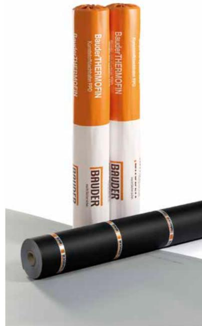
BauderTHERMOFIN F 15/18/20 sind Kunststoffdachbahnen, die in Dicken von 1,5 bis 2,0 mm hergestellt und mit einer Glasvlieseinlage armiert werden. Diese Spezialeinlage verleiht ihnen eine hohe Maßstabilität, hohes Dehnverhalten und gewährleistet die geforderten Brandeigenschaften.
