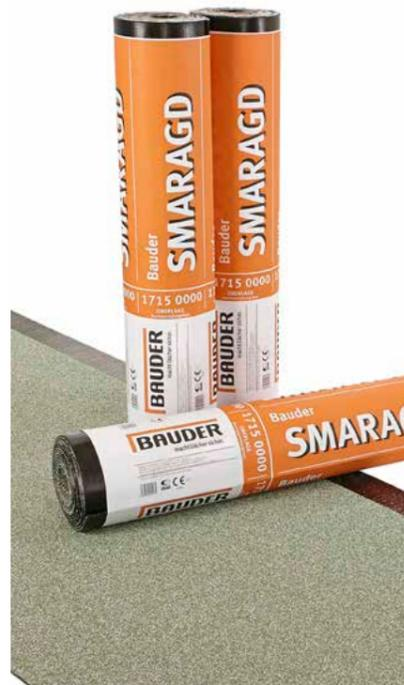
Polymerbitumen-Schweißbahn. Mechanisch extrem hochbelastbare Polyesterverbundträgereinlage in Verbindung mit einer höchstwertigen Bitumenrezeptur und integriertem Wurzelschutz.
