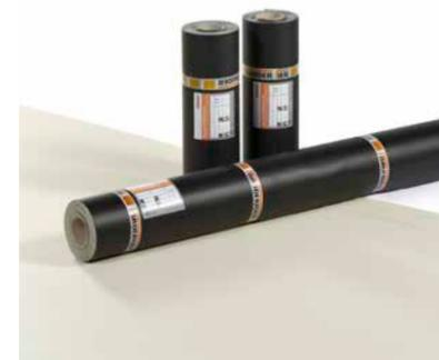
BauderTHERMOPLAN T TL ist eine 1,5 mm dicke, trägerlose Kunststoffdachbahn. Sie ist hoch dehnfähig und daher systemergänzend zu BauderTHERMOPLAN T für Detailausbildungen einsetzbar.
