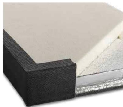
BauderVIP TE sind Terrassendämmplatten mit Vakuum-Isolier-Kern, oberseitig mit 17 mm BauderPIR, unterseitig mit 3 mm dicker Gummigranulatmatte.
