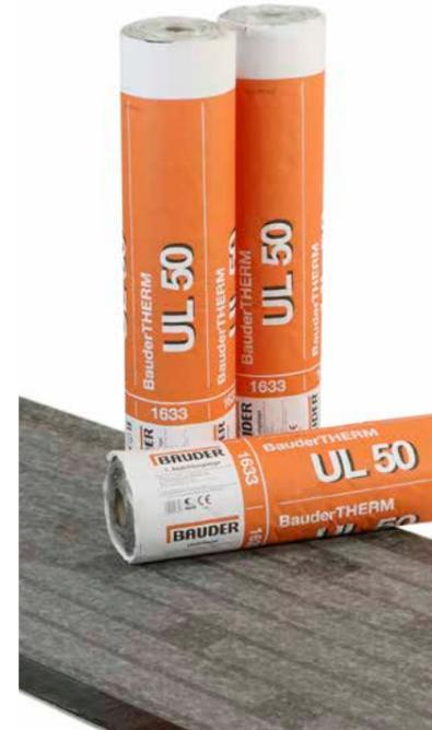
Diese Bahnen aus Spezial-Elastomerbitumen bestehen durch ihre minimale Anflämmzeit – ermöglicht durch die THERM-Streifen an der Unterseite. Aufgrund der geringen Hitzeentwicklung werden BauderPIR Dämmstoffe nicht beschädigt. Zugleich sparen Sie Energie, Material und Zeit. Die bestreuten Zonen zwischen den THERM-Streifen sorgen für kontrollierte Dampfdruck-Entspannung bei versehentlich eingeschlossener Feuchtigkeit. So wird eine mögliche Blasenbildung vermieden.
