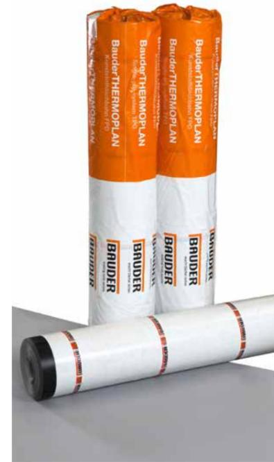
BauderTHERMOPLAN SK 15/18 sind Kunststoffdachbahnen, die in Dicken von 1,5 und 1,8 mm hergestellt werden. Sie sind mit einer Spezialverstärkung aus Gitter und Glasvlies ausgestattet und zusätzlich unterseitig mit einem PES-Vlies und Kaltselfstklebeschicht kaschiert.
