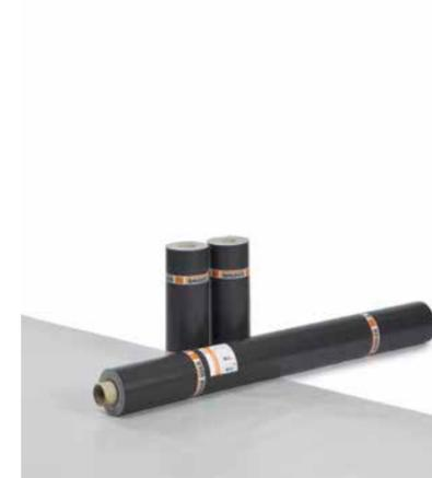
BauderTHERMOFOL D ist eine 1,8 mm dicke, trägerlose Kunststoffdachbahn. Sie ist hoch dehnfähig und daher systemergänzend zu BauderTHERMOFOL U und M für Detailausbildungen einsetzbar.
