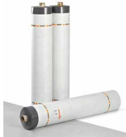
BauderTHERMOFOL U 15 V ist eine 1,5 mm dicke PVC-P - Kunststoffdachbahn, die mit einer Synthefaserverstärkung armiert und zusätzlich unterseitig mit einem Spezialvlies kaschiert wird. Dies verleiht ihr neben den bewährten Eigenschaften der gewebeverstärkten Bahnen die Möglichkeit zur windsicheren Verklebung mittels zugelassener PU-Kleber.
