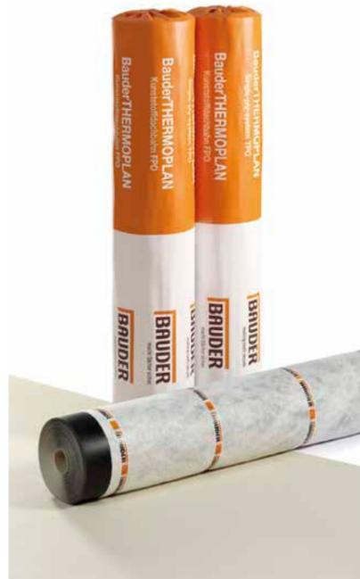
BauderTHERMOPLAN T 15/18/20 V sind Kunststoffdachbahnen, die in Dicken von 1,5 bis 2,0 mm hergestellt werden. Sie sind mit einem Synthegewebe verstärkt und zusätzlich unterseitig mit einem Spezialvlies kaschiert. Dies verleiht ihnen neben den bewährten Eigenschaften der gewebeverstärkten Bahnen die Möglichkeit zur windsicheren Verklebung mittels zugelassener PU-Kleber.
