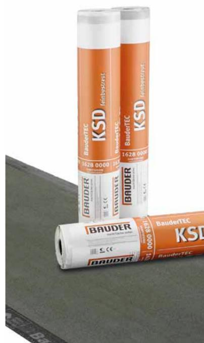
Kaltselbstklebende Elastomerbitumen-Dampfsperrbahn mit sicherer Nahtverklebung und rutschfester, feinbestreuter Bitumen-Oberfläche. Unten kaltselbstklebend auf Trapezblech bzw. mit perforierter Abziehfolie zur Verwendung als Trennlage auf Holz. Durch Verschweißung der Nähte kann eine Behelfsabdichtung sicher hergestellt werden.
