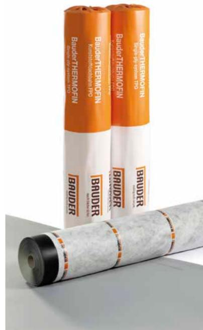
BauderTHERMOFIN F 15/18/20 V sind 1,5/1,8/2,0 mm dicke Kunststoffdachbahnen, die mit einem Glasvlies armiert und zusätzlich unterseitig mit einem Spezialvlies kaschiert werden. Dies verleiht der Dachbahn neben den Eigenschaften der Standardbahn die Möglichkeit zur windsog-sicheren Verklebung mittels zugelassener PU-Kleber.
